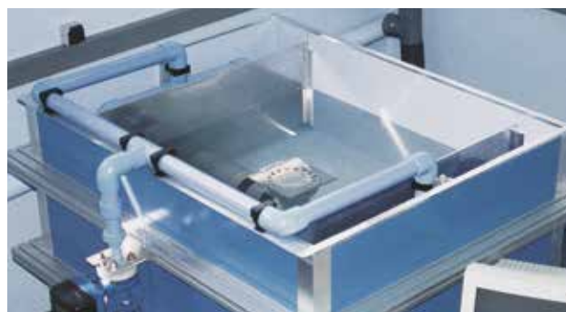
Prova di evacuazione su un chiusino sifonato.
